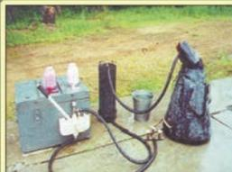
Тканево-угольный фильтр ТУФ-200 предназначен для очистки воды от естественных загрязнений, ее дезактивации, обеззараживания и обесцвечивания.
